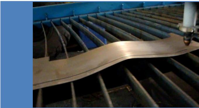
Принцип работы контроля высоты основан на измерении напряжения дуги плазматрона при его работе. В связи с этим нет необходимости в установке на резке дополнительных неудобных тарелок и внешних навесок.
